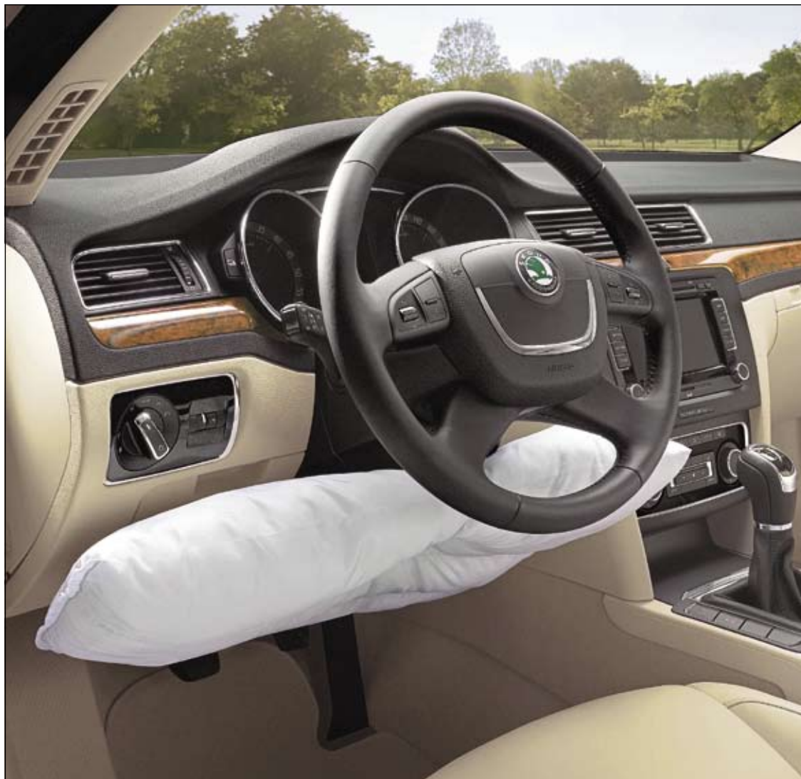
Кроме привычных фронтальных и боковых подушек и шторок, появилась подушка для защиты коленей водителя.
