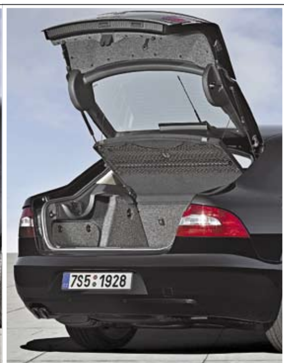
... а две последовательно – дверь вместе со стеклом, как у лифтбека.
