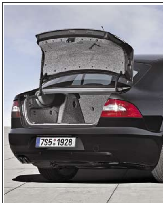
Система Twindoor позволяет, нажав одну кнопку, открыть лишь крышку багажника, как в седане...
